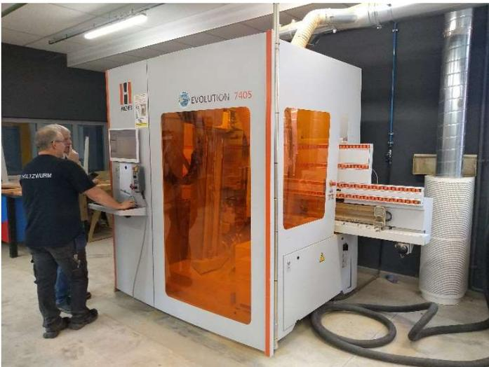
Das Programm wird mit der integrierten Software WOODWOP (Homag) oder NC-Hops (Holzher) erstellt, die sich auf dem lokalen Computer der Maschine befinden, die G-Codes für die Bedienung der CNC-Maschine erstellen können.
