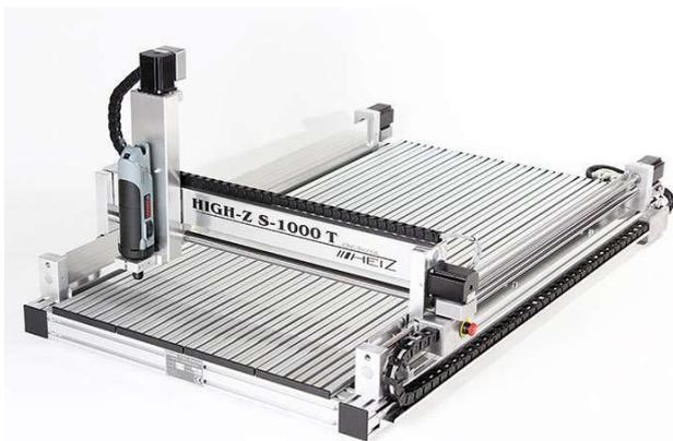
Vor der Verwendung des Geräts ist ein Programm erforderlich, das in der Regel in einer Software erstellt wurde, die G-Code generiert. Es verarbeitet hauptsächlich flache Gegenstände wie Bretter, aber auch komplexere Teile wie Stuhlbeine sind möglich. Das Sichern von Werkstücken kann jedoch eine Herausforderung sein, da diese Maschinen in der Regel nicht über eingebaute Spann- oder Absaugsysteme verfügen.
